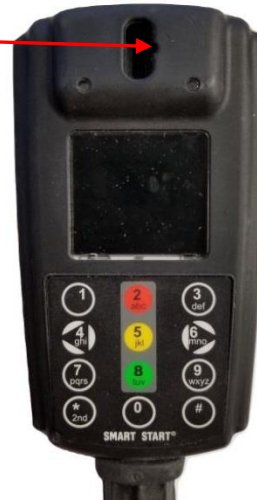
Figura 2 Pag-install ng Mouthpiece
