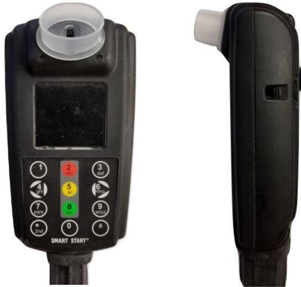
図4 正しく挿入されたマウスピース
