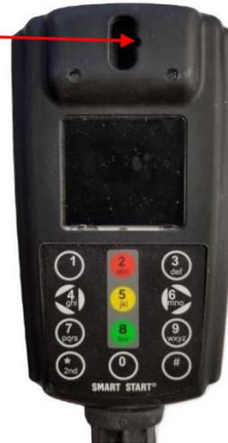
図2 マウスピースの取り付け
