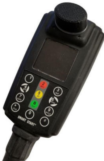
図 6 マウスピースカバーを装着したヘッドユニット
