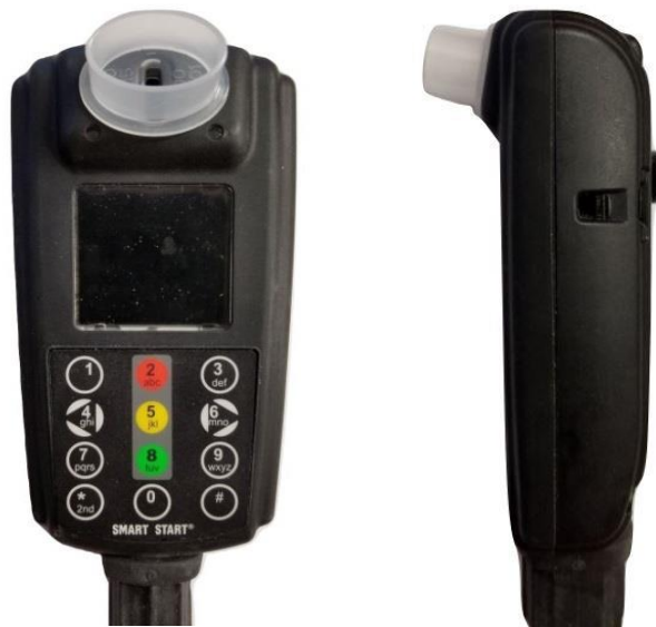
図4 正しく挿入されたマウスピース
